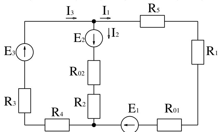
**3.** В каких режимах работают электрические машины с ЭДС  $E_1$  и  $E_2$ ? Определите токи в цепи. Дано:  $E_1=E_2=240$  В;  $R_3=30$  Ом.
