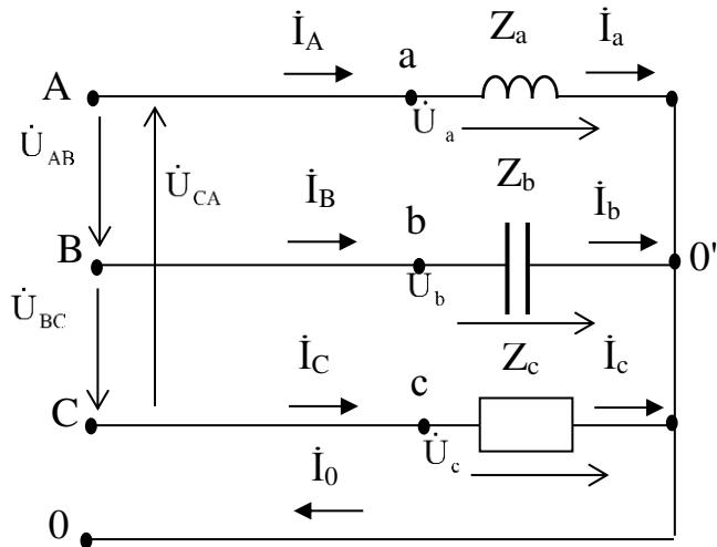
**8.** В трехфазную электрическую сеть с линейным напряжением 380 В включен трехфазный приемник. Дано: мощность фаз приемника:  $S_a=5,2\text{ кВА}$ ;  $Q_b=4,5\text{ кВАр}$ ;  $P_c=2,6\text{ кВт}$ ;  $\phi_a=\phi_b=\phi_c=-60^\circ$ . Изобразите схему замещения цепи. Определите все мощности трехфазного приемника, фазные токи и сопротивления фаз. Постройте векторную диаграмму.
