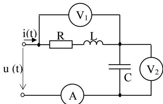
**8.** Определить показания приборов электромагнитной системы в цепи, схема которой показана на рисунке, записать выражение мгновенного значения тока, если:  $R = 50 \text{ Ом}$ ,  $\omega L = 10 \text{ Ом}$ ,  $\frac{1}{\omega C} = 90 \text{ Ом}$ . На вход цепи подано несинусоидальное напряжение, заданное в виде аналитического разложения в ряд Фурье  $u(t) = 100 + 310\sin(\omega t+30^\circ) + 106\sin(3\omega t-30^\circ) \text{ В}$ .
