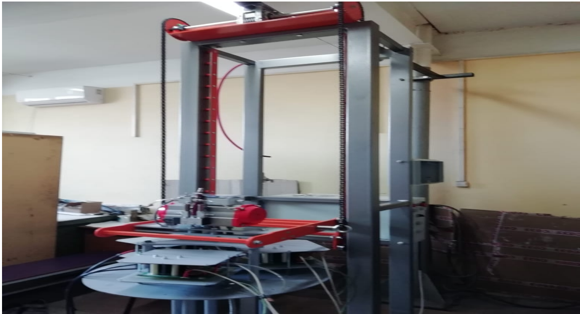
Рис. 1. Установка с возвратно-поступательным механизмом
