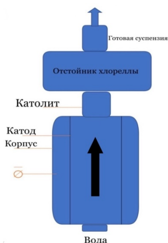
Рисунок. Схема установки ускоренного выращивания хлореллы
