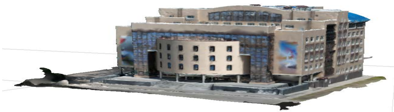
Рис. 2. 3D-модель, построенная в Agisoft Metashape
