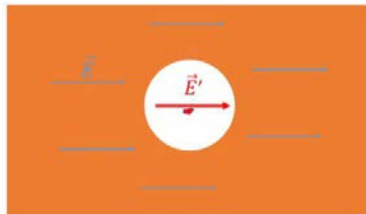
Рис. 2. Модель Дебая: Молекула растворного вещества испытывает электрическое поле внутри полости (белого цвета) диэлектрика, но не взаимодействует с соседними молекулами.
