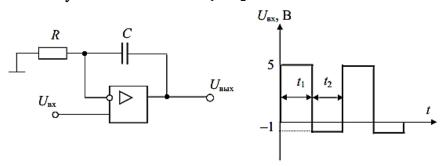
Ответ: За время t1 напряжение на конденсаторе нарастает на 5 B, за время t2 спадает на 1 B. После окончания импульсов напряжение на выходе интегратора не изменяется.
