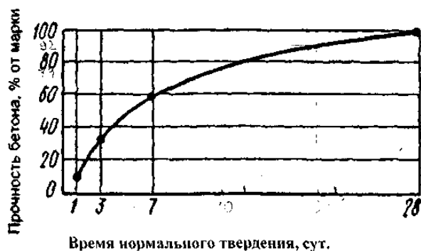
Рис. 11. Нарастание прочности бетонов в нормальных условиях твердения
