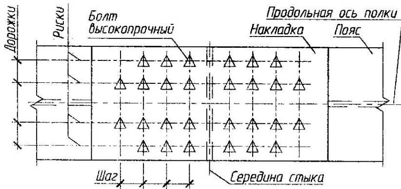
Рис. 16. Пример возможного расположения высокопрочных болтов в стыке полки
