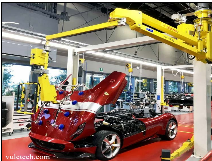
Рис. 1.7. Робот-манипулятор выполняет сборку автомобиля
