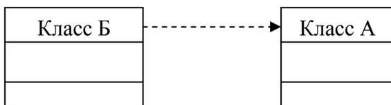
Рис. 33. Графическое изображение отношения зависимости на диаграмме классов
