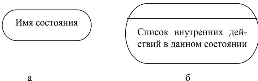
Рис. 49. Графическое изображение состояний
