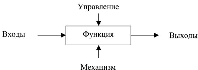
Рис. 8. Функциональный блок и интерфейсные дуги
