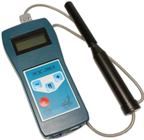
**Метеометр МЭС-200А** предназначен для измерений атмосферного давления, относительной влажности воздуха, температуры воздуха, скорости воздушного потока, концентрации оксида углерода, сероводорода и диоксида серы в смеси с азотом или воздухом как внутри помещений, так и вне помещений), а также расчета температуры влажного термометра и параметров тепловой нагрузки среды ТНС-индекса.
