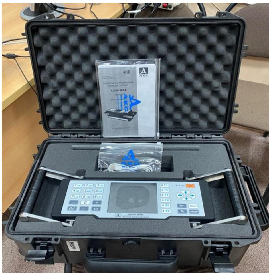
Предназначен для контроля конструкций из бетона, железобетона, камня и полимербетонных изделий при одностороннем доступе к ним с целью определения целостности материала в конструкции, поиска инородных включений, полостей, непроливов, расслоений и трещин, а также измерения толщины объекта контроля, наличия и расположения арматуры в нем.
