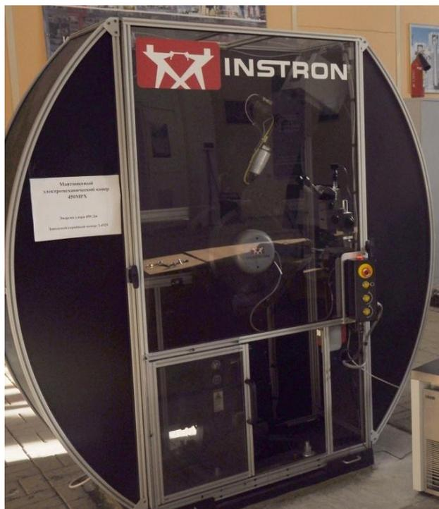
Данное оборудование позволяет автоматически определить ударную вязкость - способность материала поглощать механическую энергию в процессе деформации и разрушения под действием ударной нагрузки. Испытание проводят на образцах с U и V типами надрезов и размерами в соответствии с НТД на продукцию для испытаний.
