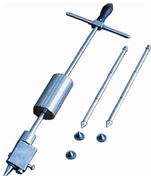
Динамический плотномер предназначен для контроля качества уплотнения земляного полотна, песчаных и мелкозернистых асфальтобетонных покрытий.
