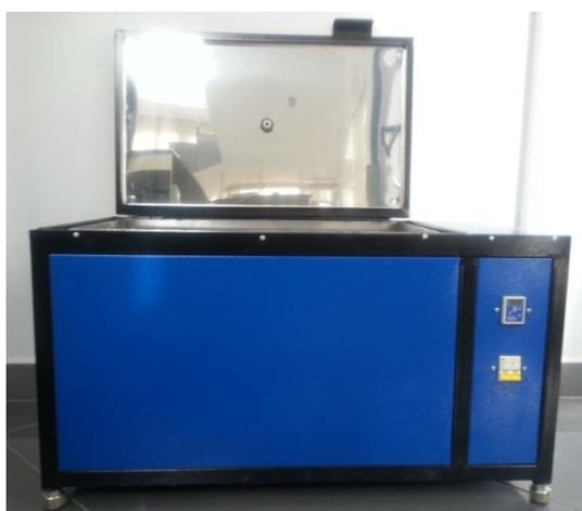
Ванна предназначена для оттаивания бетонных образцов при температурных испытаниях на морозостойкость конструкционных тяжелых, легких и плотных силикатных бетонов при замораживании по ускоренному и базовому методам в соответствии с ГОСТ 10060-2012.
