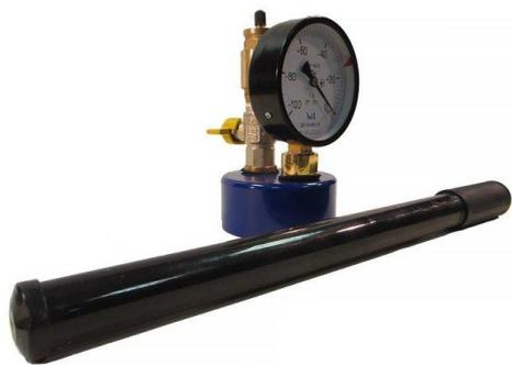
Предназначен для ускоренного определения водонепроницаемости бетона на образцах, изготовленных из бетонной смеси рабочего состава, либо выпиленных, выбуренных из изделий и конструкций по ГОСТ 12730.5-84, приложение 4.
