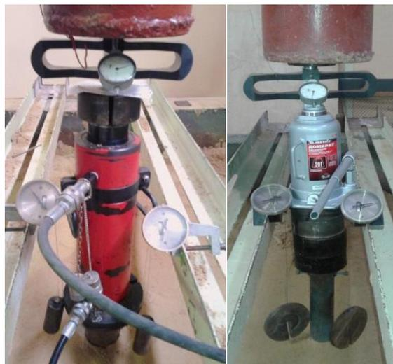
Схема установки для испытания цилиндрической модели фундамента с 50т и 20т гидравлическим домкратом
