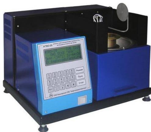
Аппарат предназначен для определения температуры вспышки нефтепродуктов в открытом тигле по методу Кливленда в соответствии с ГОСТ 4333-87, ISO 2592, ASTM D 92. Аппарат разработан с учетом всех требований российских и международных стандартов к проведению испытаний.
