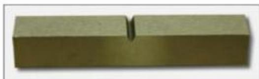
Образец с концентратором вида "V"
