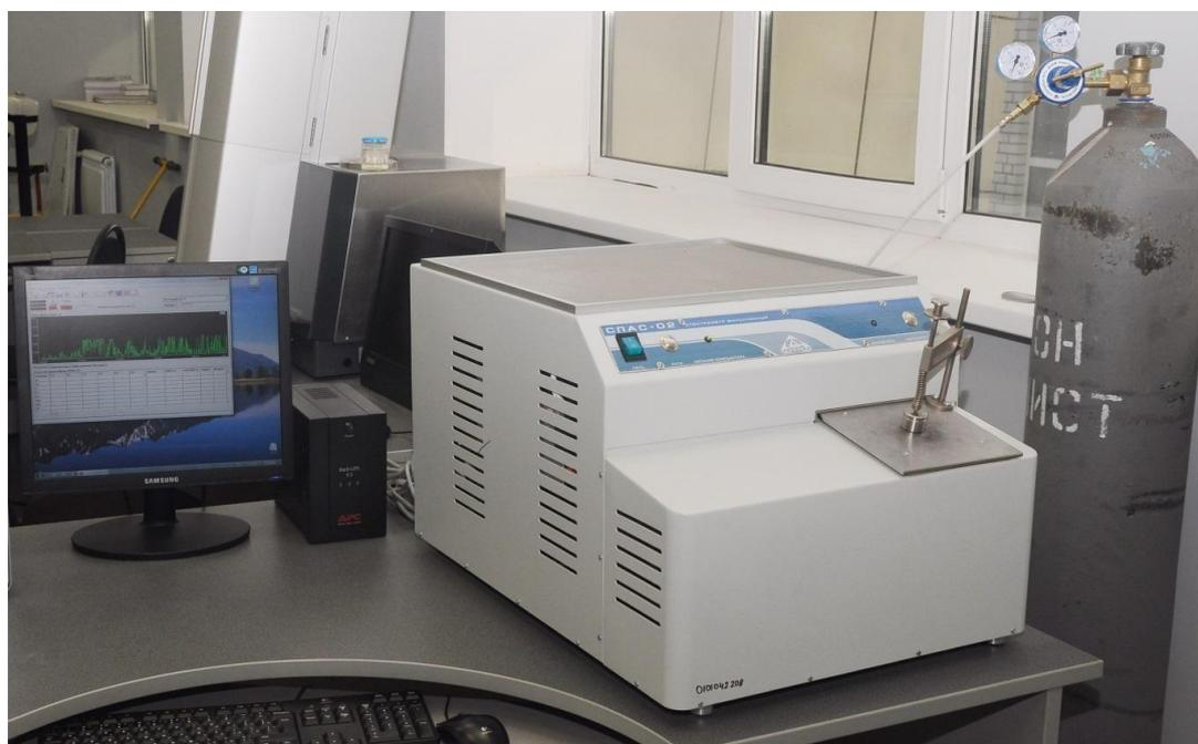
Предназначен для высокоточного элементного анализа металлов и сплавов, обеспечивает экспрессность, надежность и высокую точность результатов определения полного элементного состава металлопродукции. Необходим для контроля сырья и продукции черной и цветной металлургии, горнодобывающей, обогатительной, перерабатывающей, пищевой и других отраслей промышленности. Автоматизированная система управления и обработки данных.
