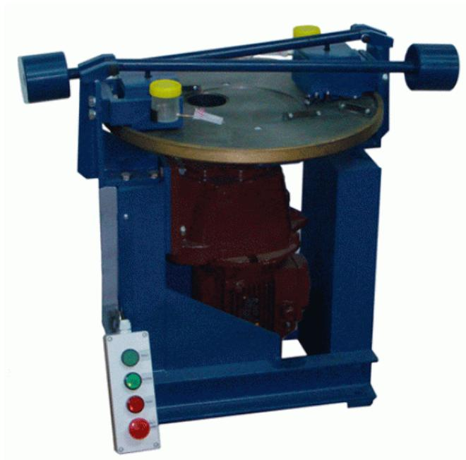
Лабораторный круг истирания ЛКИ-3 на два образца. Предназначен для определения истираемости бетонов дорожных полов, лестниц и других конструкций сухим абразивом по ГОСТ 13087-81; износостойкости не глазурованных керамических плиток по ГОСТ 27180-2001. Модель ЛКИ-3 позволяет проводить одновременно 2 испытания.
