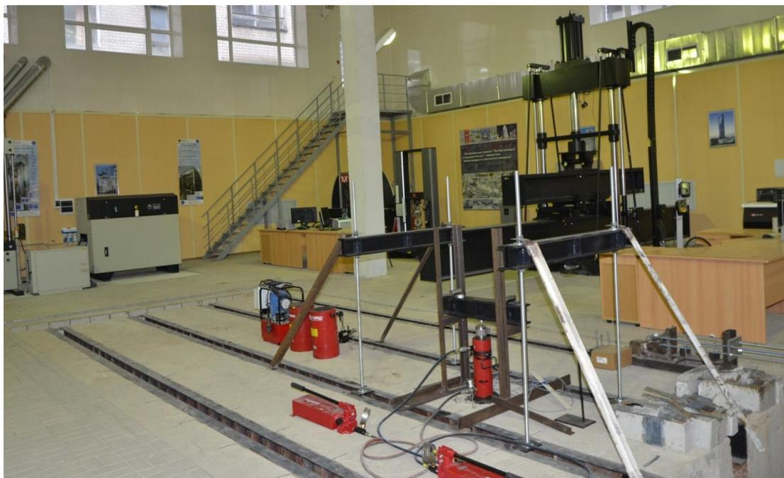
Силовой пол – это высокоармированная монолитная плита размером 74 м, которая служит как высокопрочное основание для проведения натурных испытаний строительных конструкций различной конфигурации. Нагрузка на испытываемую конструкцию передается с помощью универсальных гидравлических домкратов грузоподъемностью от 50 до 200 тс. Особенность силового пола - плита не связана с фундаментной частью под каркасом здания, что исключает передачу нагрузки, при проведении испытаний, с силового пола на здание.
