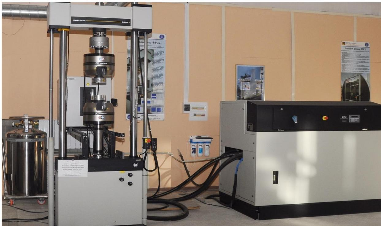
Система, предназначенная для выполнения испытаний на растяжение, сжатие изгиб, релаксацию/ползучесть, отслаивание, адгезию, трение в статическом и динамическом режиме. Это уникальное по своему техническому уровню оборудование, позволяющее быстро и качественно проводить испытания образцов материалов и узлов по знакопеременным законам нагружения.
