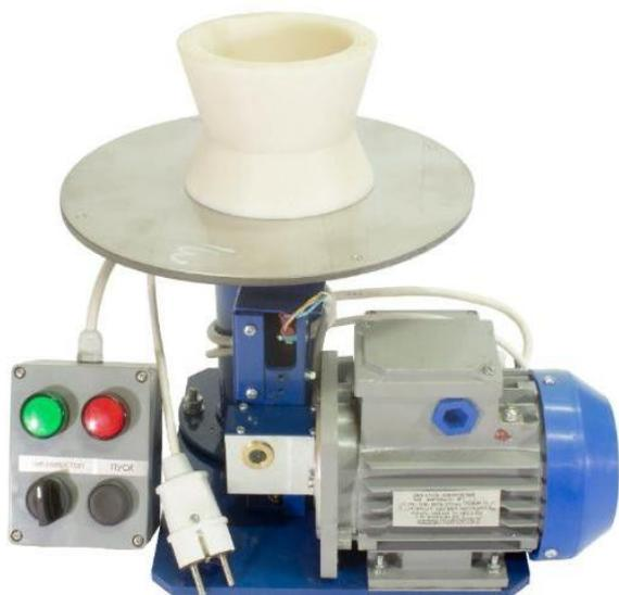
**Принцип действия:** за нормальную густоту пластичного раствора принимается такая его консистенция, при которой растекание раствора после 30 встряхиваний столика составляет 125-135 мм.
