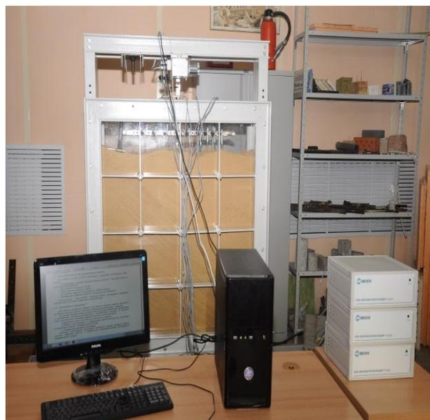
Используя методику цифровой обработки образов, стенд позволяет измерить перемещения частиц грунта и построить поля деформаций сдвига и объемных деформаций грунтов.
