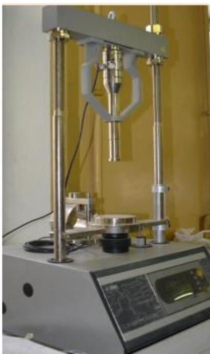
Пресс UNIFRAME T108/E предназначен для испытаний на сжатие и сдвигу стойчивость асфальтобетона ГОСТ 12801 «Материалы на основе органических вяжущих для дорожного и аэродромного строительства. Методы испытаний».
