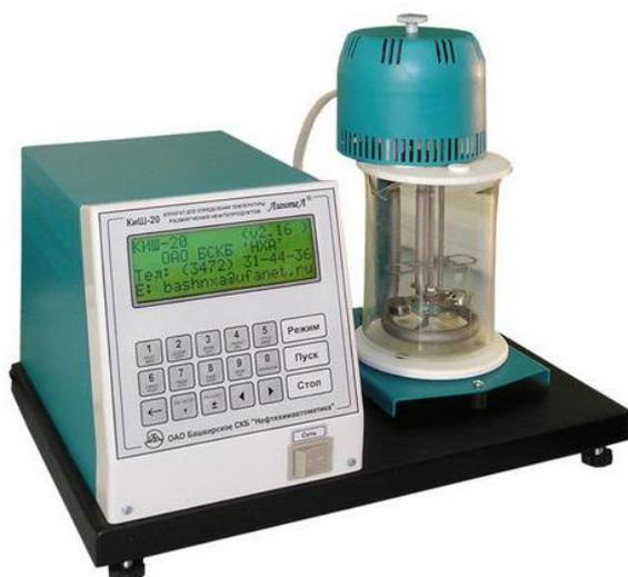
Аппарат для определения температуры размягчения нефтебитумов по ГОСТ 11506-73, ASTM D 36, ISO 4625 Реализует метод "Кольцо и шар".
