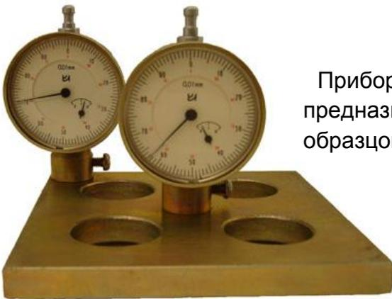
Прибор для измерения отклонений от плоскостности НПЛ-1 предназначен для определения отклонений опорных граней образцов бетона от плоскости по ГОСТ 10180.
