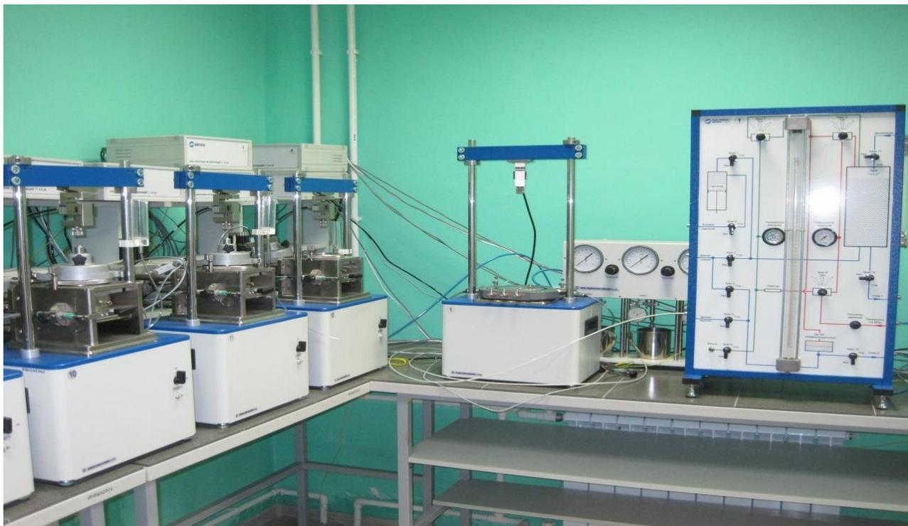
Комплекс предназначен для проведения механических испытаний природных и промышленных строительных материалов: грунтов, асфальтобетонов, цементов при различных видах напряженного состояния и траекториях нагружения.
