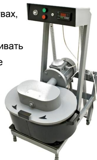
Конструкция обеспечивает хороший доступ к деталям, требующим периодической очистки от налипающих частиц, простоту замены изнашиваемых элементов - лопастей и емкости.
