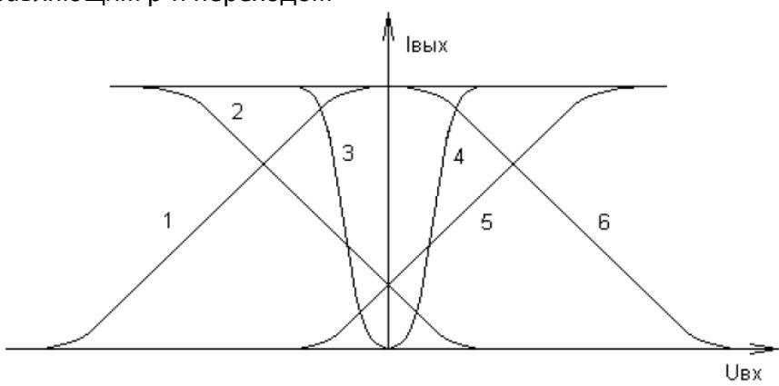
60. Проходная динамическая характеристика полевого транзистора p типа с управляемым p-n переходом
