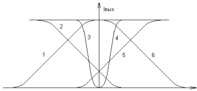
61. Проходная динамическая характеристика полевого МОП - транзистора p типа
