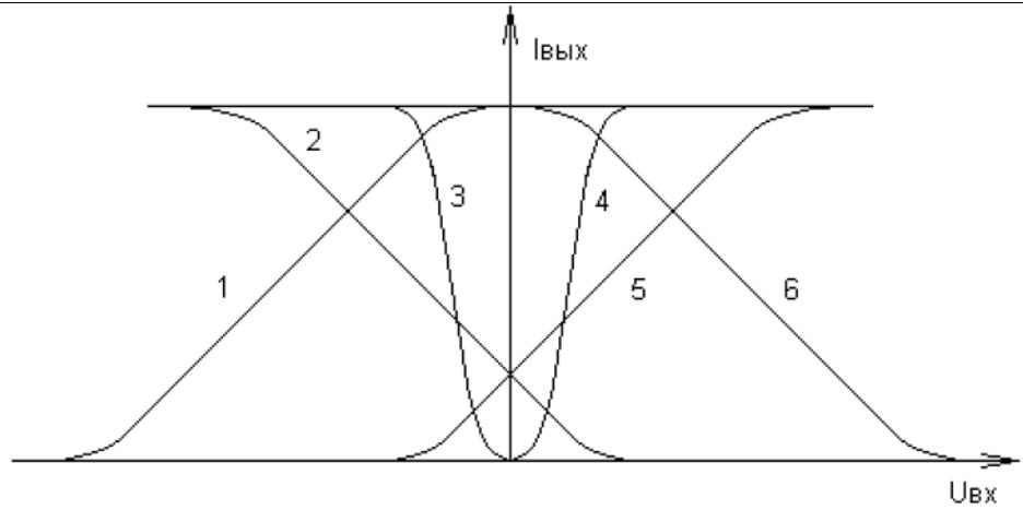
59. Проходная динамическая характеристика полевого транзистора n типа с управляемым p-n переходом
