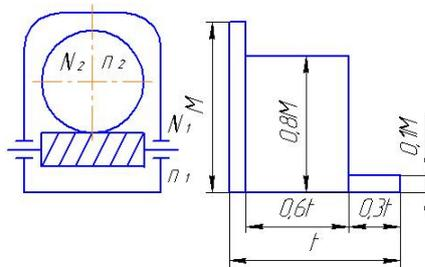
Рис. 4 Схема редуктора и график нагрузки
