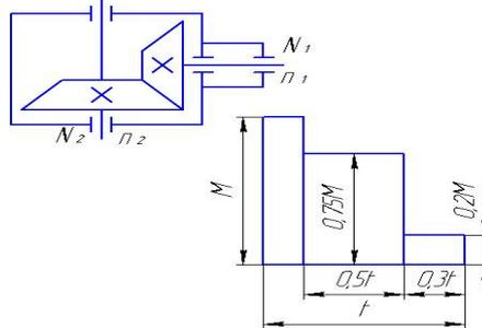
Рис. 2 Схема редуктора и график нагрузки
