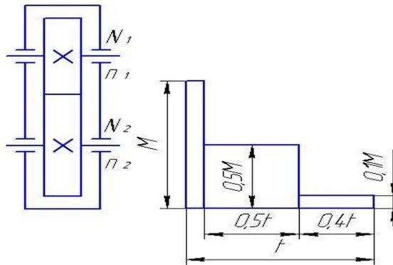
Рис. 1 Схема редуктора и график нагрузки
