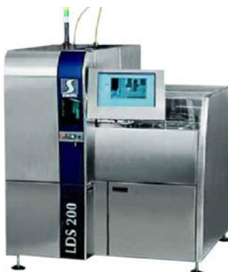
Рис. 2.7. Установка лазерной обработки LDS200M Параметры установки лазерной обработки LDS200M: - точность позиционирования \pm 3 мкм; - ширина реза 20 мкм;
