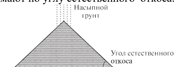
Рис. 2.3. Схема определения угла откоса для несвязного грунта
