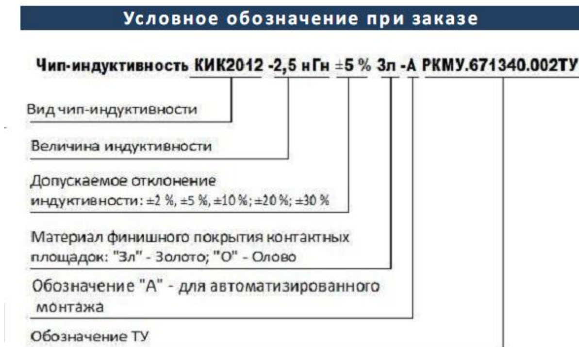
Рис. 11. Структура ПУО отечественных высокочастотных и сверхвысокочастотных чип-индуктивностей
