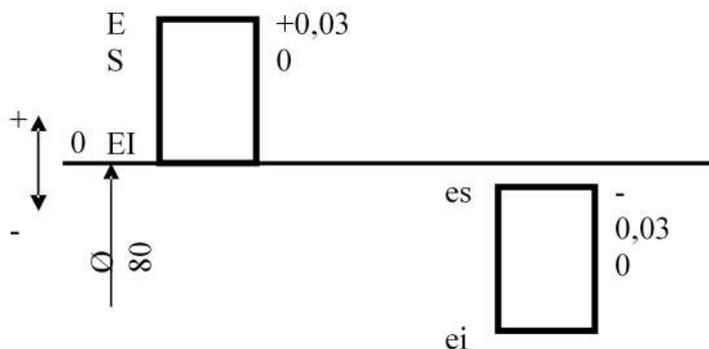
Предельные зазоры равны, мм
