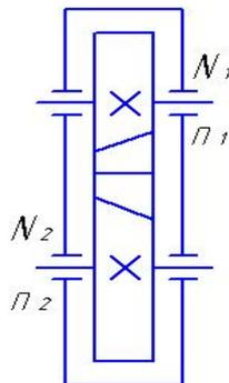
Рис. 3 Схема редуктора
