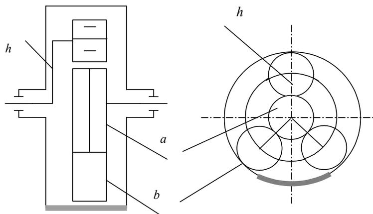
Рис. 6 Схема редуктора
