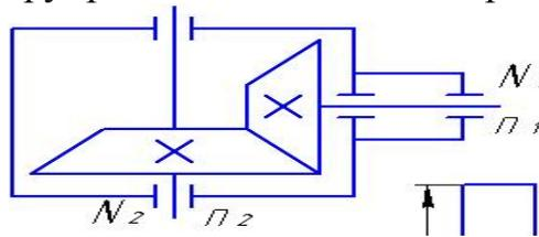
Рис. 2 Схема редуктора
