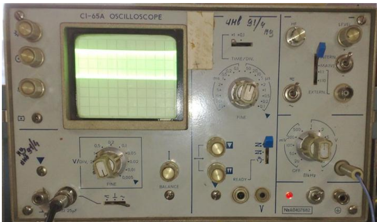
Рис. 16. Фотография осциллограммы и положение органов управления режиме срыва синхронизации при изменении уровня постоянной составляющей
