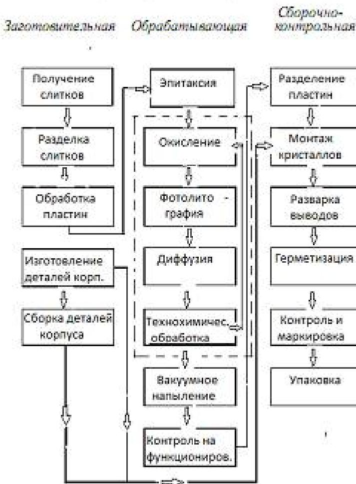
Рис. 2.4. Классификация частных технологических процессов
