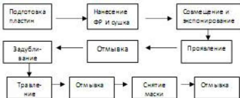
Рис. 3.20. Схема процесса фотолитографии
