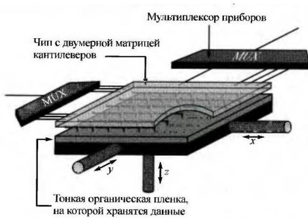
Рис. 4.16. Схема устройства ЗУ типа «многоножка»
