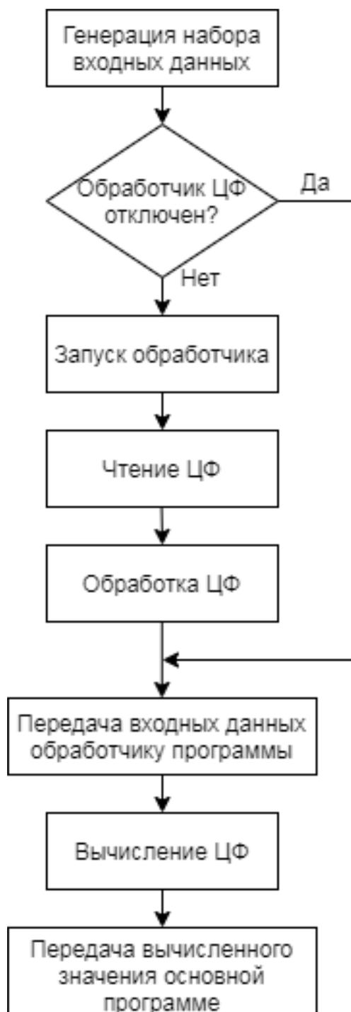
Рис. 3. Укрупненный алгоритм взаимодействия обработчика ЦФ с ИСПЭА
