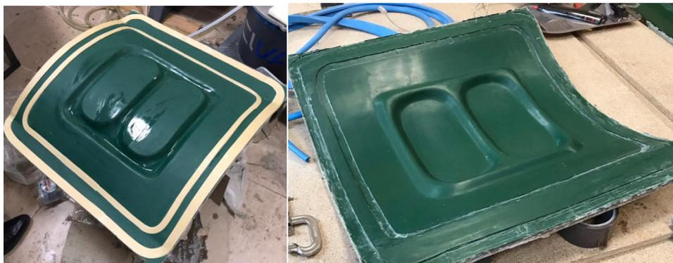
Рисунок. Многоцветная композитная оснастка
