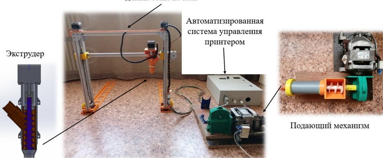
Рис. 1. Конструкция разработанного 3D-принтера
