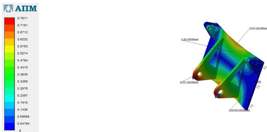
Рис. 4. Суммарные перемещения в переходной плите
