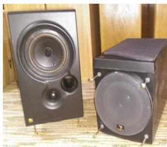
Рис. 4. Доработанная ГГ 25ГДШ-9Д, установленная в переделанные АС KEF "Coda" 7
