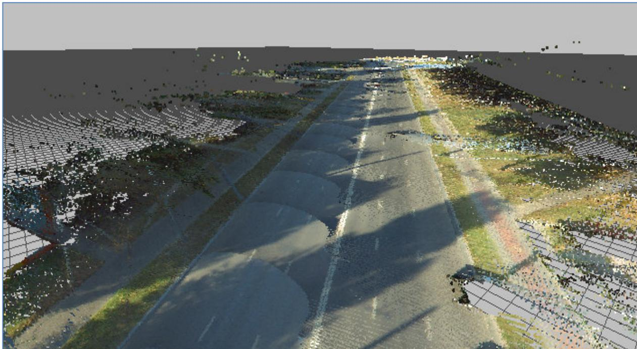
Рис. 3. Вид рельефа, выделенного из облака точек, в программе 3D СКАН
