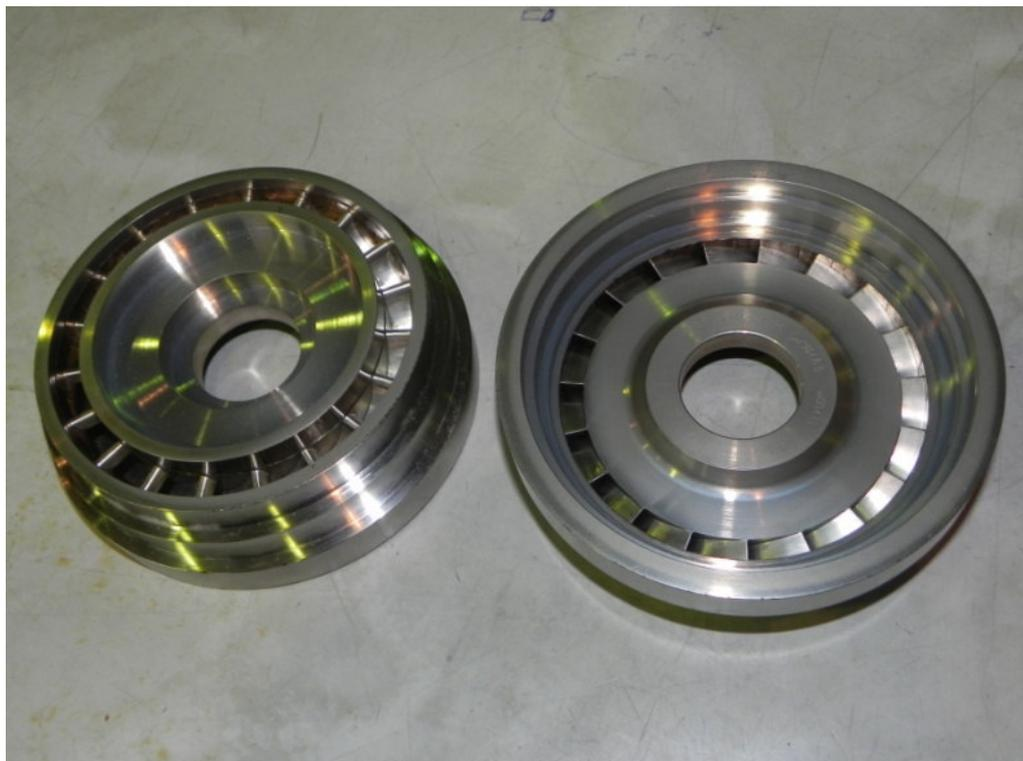
Рисунок. Типовые детали с узкими межлопаточными каналами криволинейной формы
