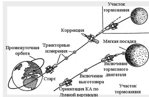
Рис.1. Орбитальный маневр космического аппарата «Луна-9»
