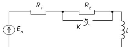
20. На рисунке изображена цепь, замыкаемая и размыкаемая рубильником  $K$ . Рубильник остается замкнутым в течение 2 секунд и разомкнутым в течение 3 секунд, причем эта операция повторяется периодически в той же последовательности. Определить выражения тока в цепи при третьем замыкании и третьем размыкании, предполагая, что  $i(0) = 0$ .
