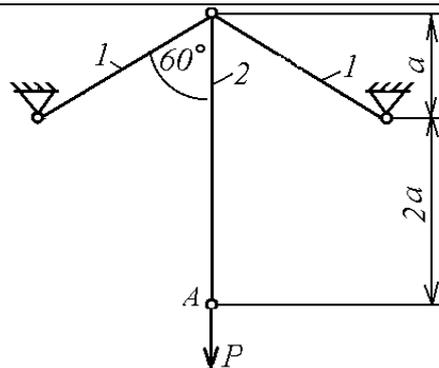
7. Определить площадь поперечного сечения стального стержня и перемещение точки А при  $[\sigma] = 160$  Мпа,  $P_1 = 20$  кН,  $P_2 = 20$  кН, если  $E = 2 \cdot 10^5$  Мпа,  $a = 0.5$  м.
