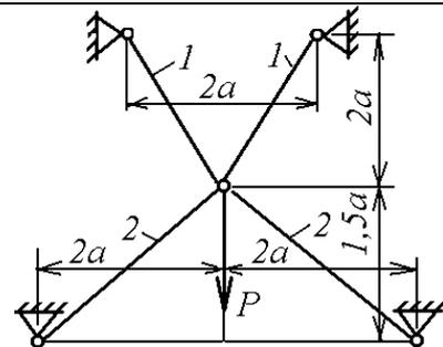
9. Стержень, изображенный на схеме, закреплен при  $t = -10\text{ }^\circ\text{C}$ . Определить напряжения при нагреве стержня на  $100\text{ }^\circ\text{C}$  при  $a = 0,2\text{ м}$ . Модули упругости меди и стали равны  $E_1 = 1,1 \cdot 10^5\text{ МПа}$ ,  $E_2 = 2 \cdot 10^5\text{ МПа}$ ,  $F = 2\text{ см}^2$ . Для стали коэффициент температурного расширения равен  $1,25 \cdot 10^{-5}\text{ 1/град}$ , для меди  $-2,5 \cdot 10^{-5}\text{ 1/град}$ .
