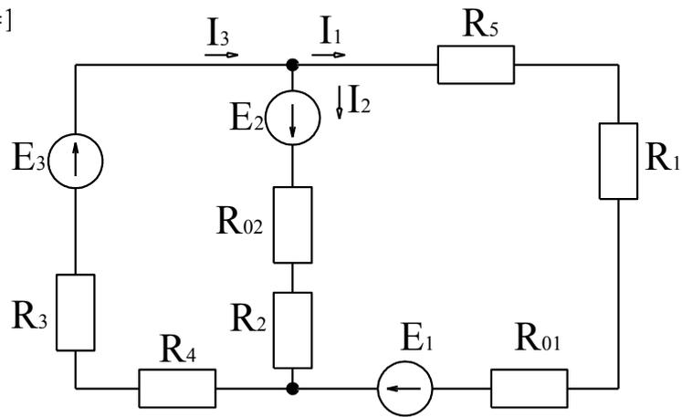
3. В каких режимах работают электрические машины с ЭДС  $E_1$  и  $E_2$ ? Определите токи в цепи. Дано:  $E_1=E_2=240\text{ В}$ ;  $R_3=30\text{ Ом}$ .
