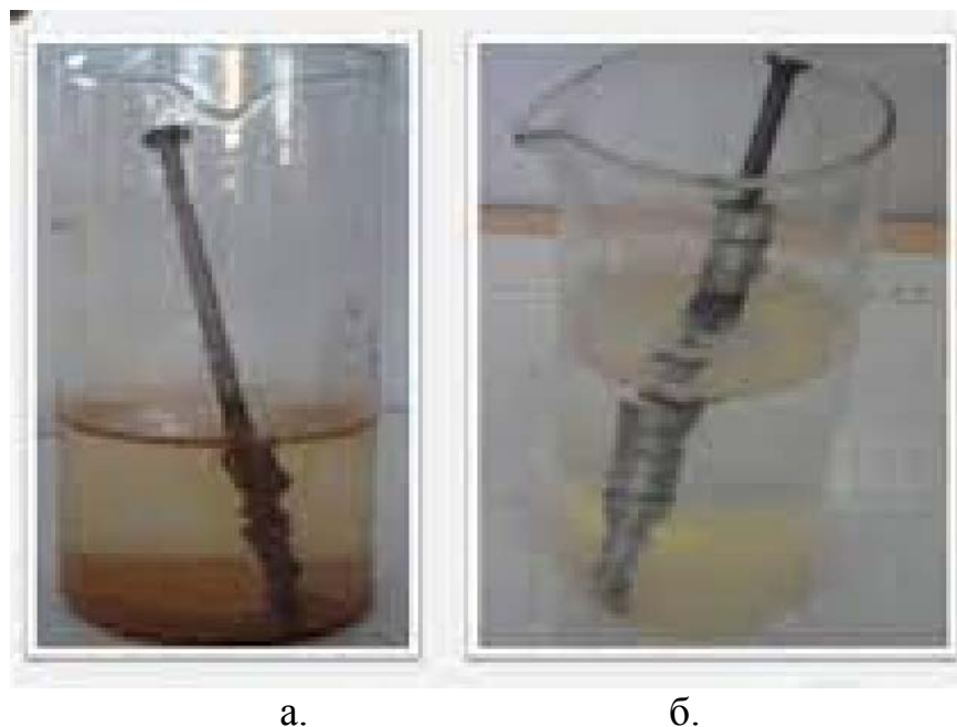
Рис.13 Коррозия при контакте двух металлов – а. железо-медь, б. железо-цинк
