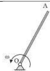
Дано:  $OA = 1$  м. Угловая скорость кривошипа изменяется по закону  $\omega = 2 \sin \frac{\pi t}{3}$  (рад/с). Определить касательное ускорение точки  $A$  в момент времени  $t_1 = 1$  с.
