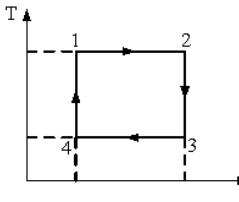
9. На рисунке изображен цикл Карно в координатах (T,S), где S – энтропия. Теплота подводится к системе на участке
