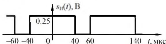
**Задание 0115.** Средняя мощность измеряемого в вольтах периодического напряжения, которое в пределах одного периода определяется выражением
