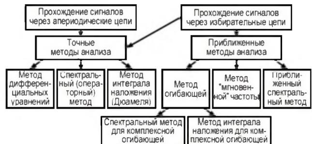
**Задание 0317.** На рисунке показана краткая классификация методов анализа линейных цепей. Один из указанных методов основан на представлении сигнала в виде совокупности комплексных гармонических колебаний разных частот и использовании комплексной частотной характеристики цепи. Это метод ...
