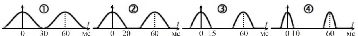
**Задание 0616.** Автогенератор построен на основе усилителя, колебательная характеристика которого представлена на рисунке. Нагрузкой усилителя служит контур с резонансным сопротивлением  $R_{кэ} = 2$  кОм. Известно, что в установившемся режиме на выходе автогенератора наблюдаются гармонические колебания с амплитудой  $U_{\text{вых}} = 12$  В. Достичь подобного результата удастся при показанной на рисунке линии обратной связи под номером ....
