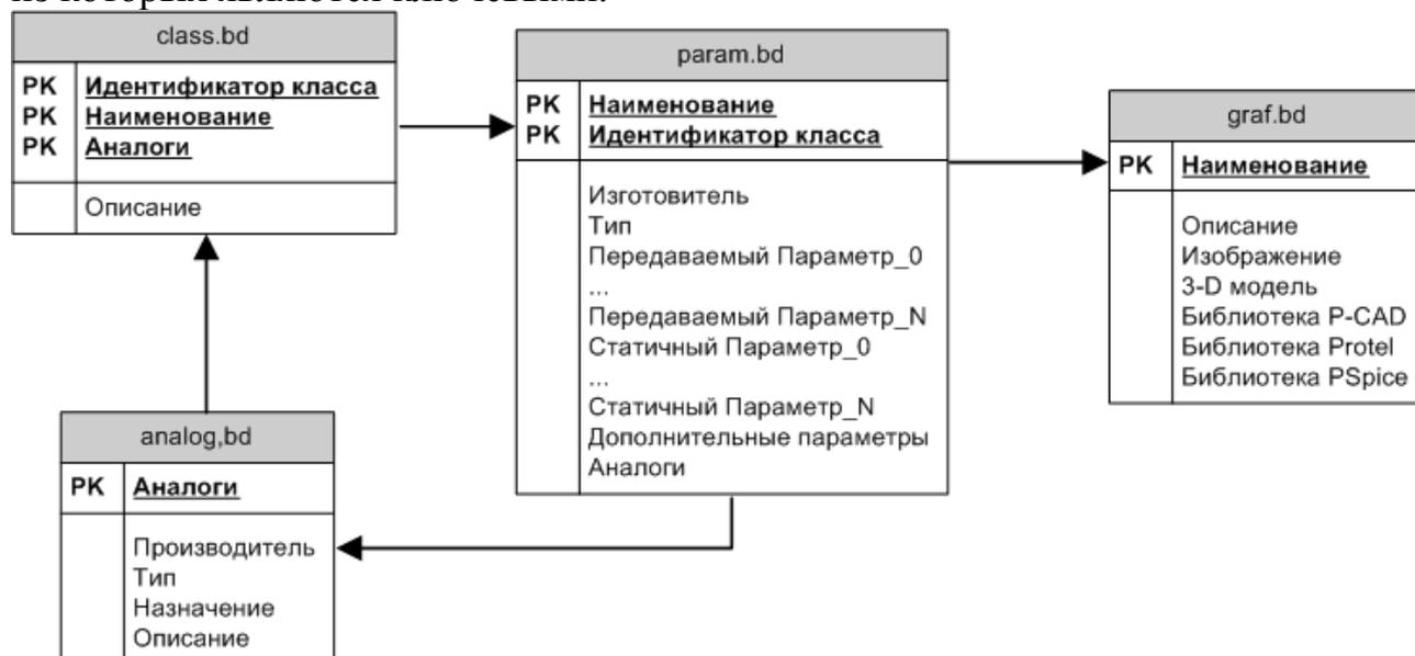
Рис 3.5. Структурная схема интегрированной базы данных полупроводниковых изделий
