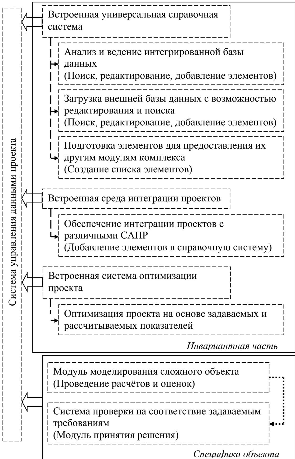
Рис. 3.2. Модульная структура программного обеспечения оценки сложных объектов
