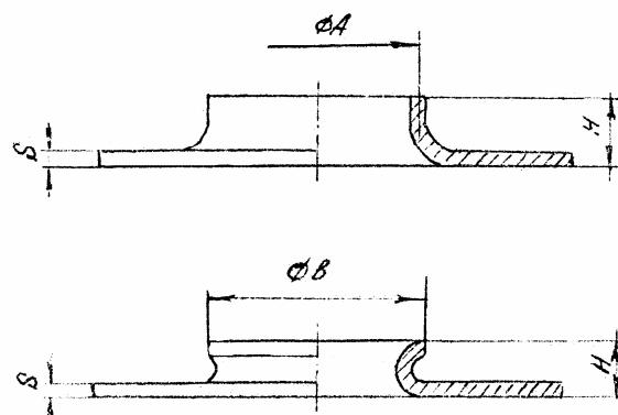
Рис. 9. Обозначение размеров элементов разбортованных отверстий.
