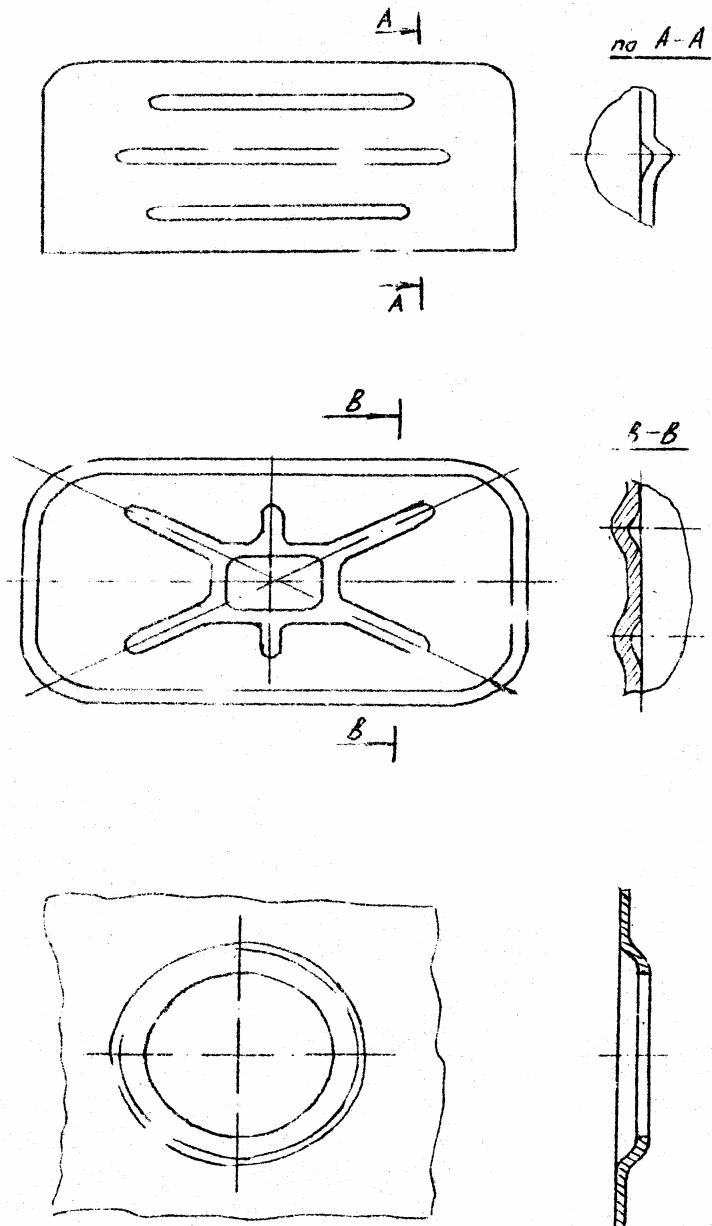
Рис. 7. Конструктивные элементы повышения жесткости деталей
