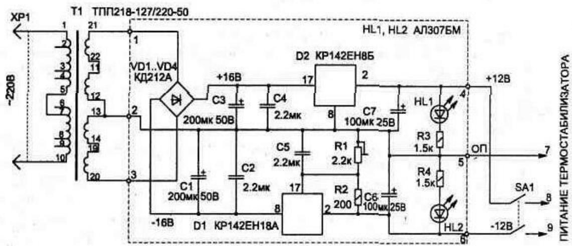
Рис. П.4. Блок питания, принципиальная схема.
