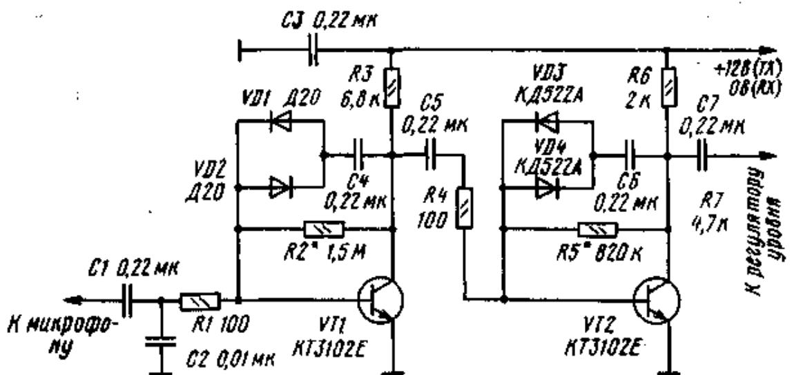
Рис. П.14. Схема НЧ ограничителя
