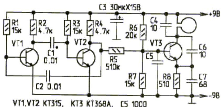
Рис. П.1. Металлоискатель
