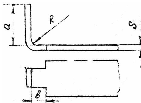
Рис. 3. Правильная конструкция выступа изогнутой детали
