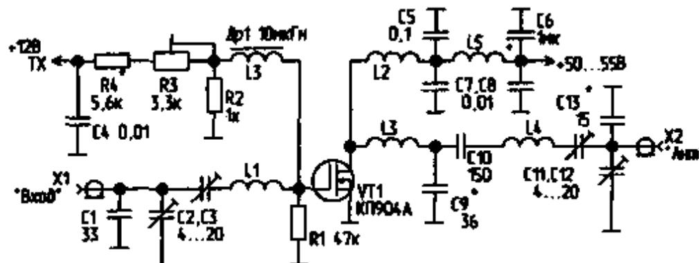
Рис. П.11. Схема усилителя мощности УКВ.
