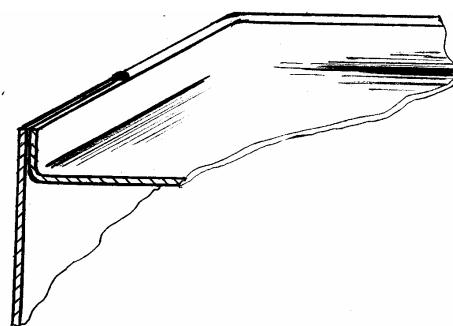
Рис. 14 - Соединение дуговой сваркой
