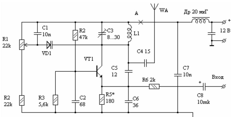
Рис. П.22. Электрическая схема видеопередатчика
