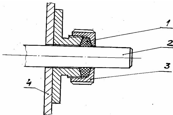
1- фетровый сальник; 2- валик; 3- накладная гайка; 4- корпус.
