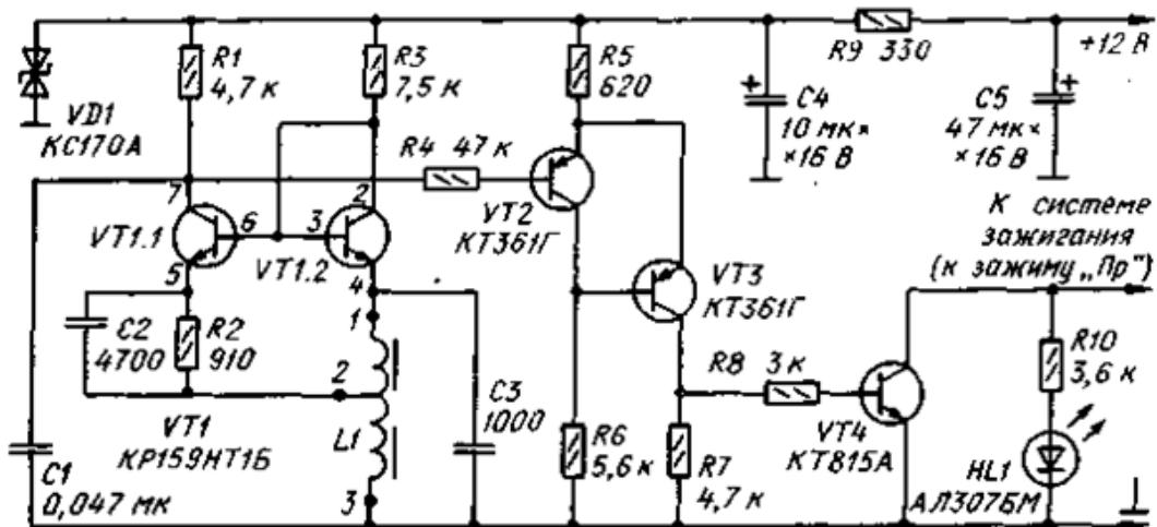
Рис. П.20. Принципиальная схема бесконтактного прерывателя.
