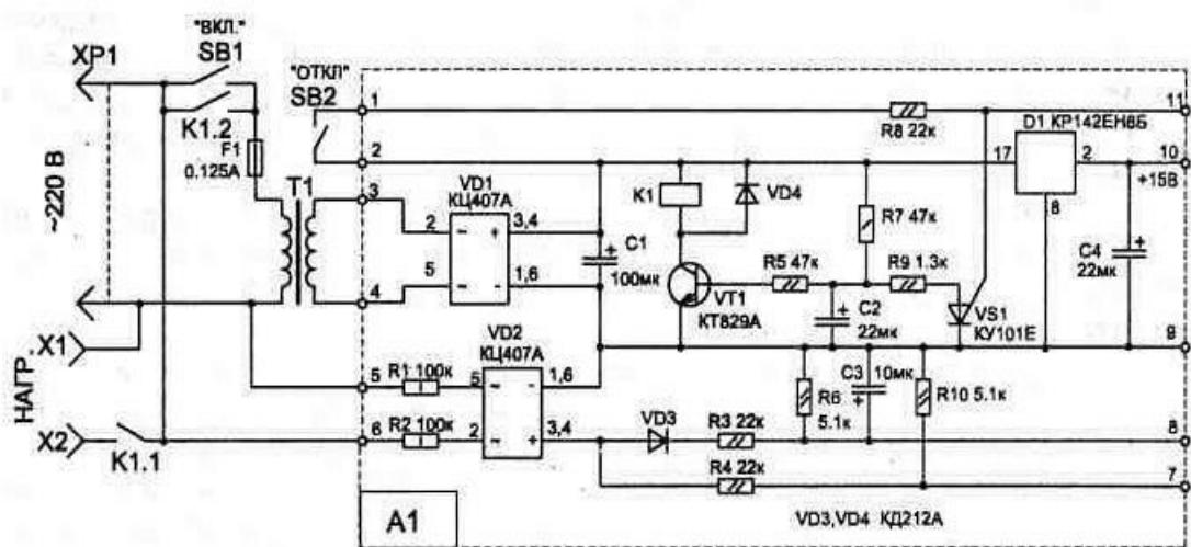
Рис. П.5. Электрическая схема устройства.
