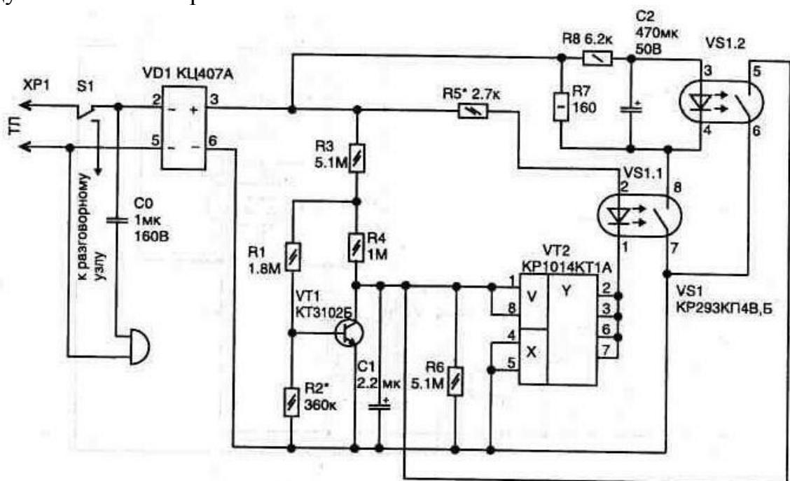
Рис. П.8. Электрическая схема блокиратора
