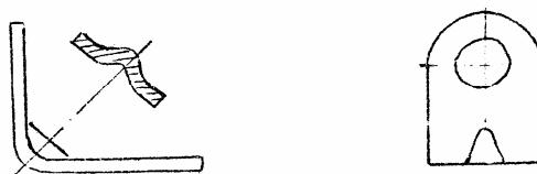
Рис. 10. Выдавка угла для повышения жесткости.
