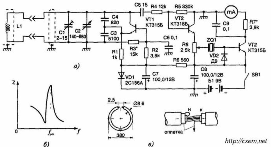
Рис. П.2. Кварцеванный металлоискатель
