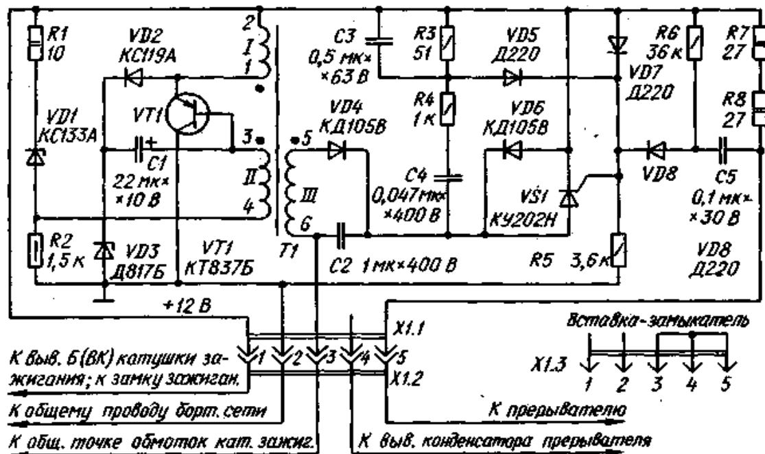
Рис. П.18. Схема блока зажигания
