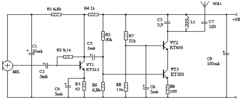
Рис. П.15. Радиомикрофон, схема электрическая
