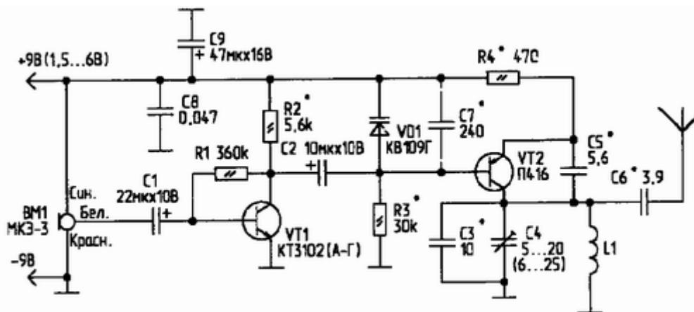
Рис. П.23. Прослушивающее устройство, схема электрическая
