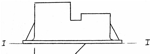
Рис. 12. Линия разъема модели — плоская
