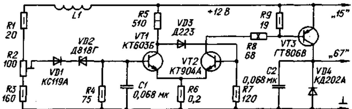
Рис. П.19. Принципиальная схема электронного регулятора.
