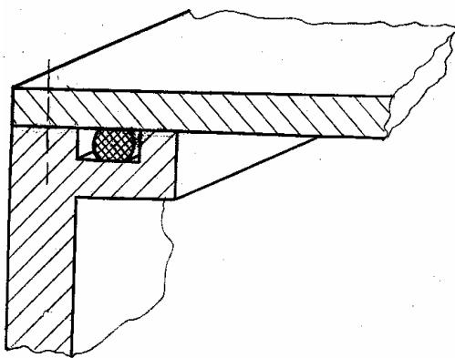
Рис. 16 - Герметизация при помощи резиновых прокладок
