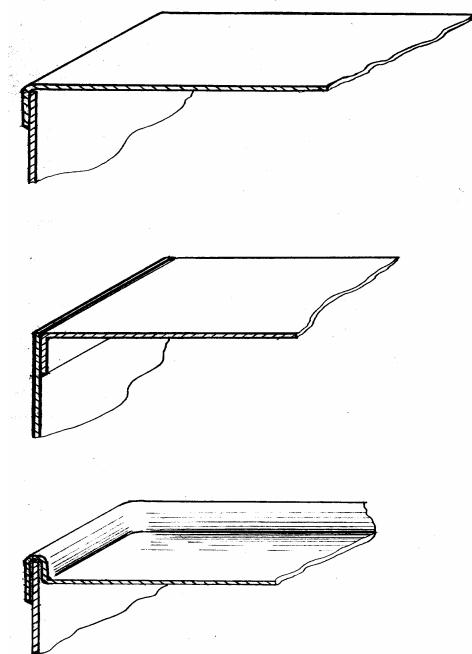
Рис. 13 - соединение пайкой: 1-“наружная крышка”;
