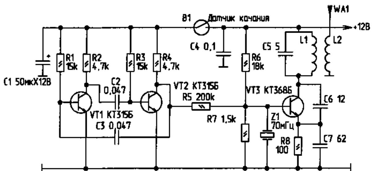
Рис. П.21. Автомобильный радиосторож
