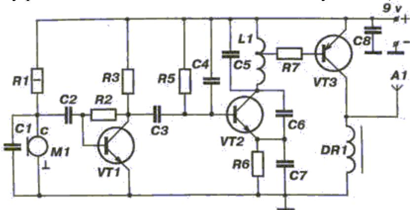
Рис. П.12. Микропередатчик, схема электрическая
