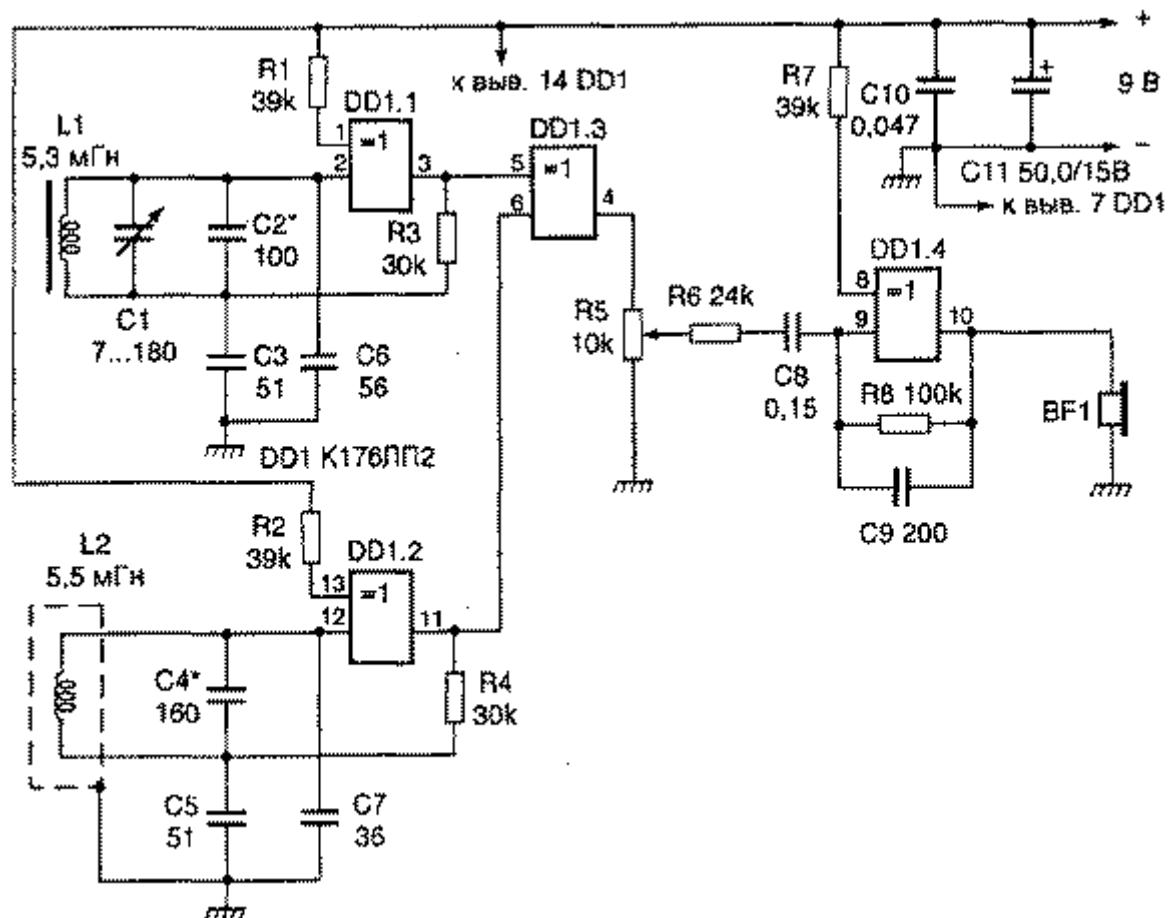
Рис. П.3. Металлоискатель, принципиальная схема.
