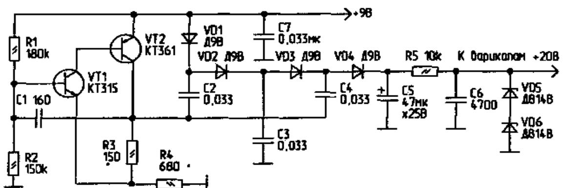
Рис. П.17. Схема преобразователя напряжения
