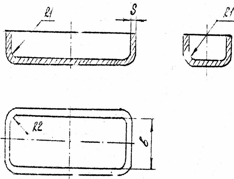
Рис. 6. Радиусы сопряжений спинок полой прямоугольной детали
