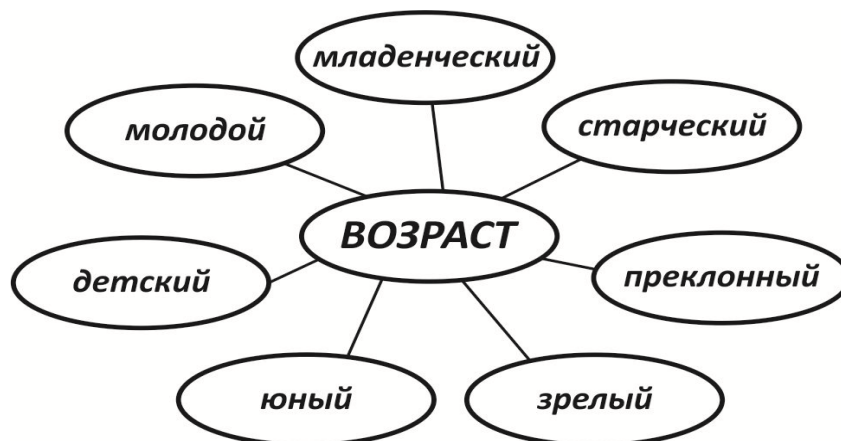
Рис. 43. Лингвистическая переменная «возраст» и нечеткие множества, определяющие ее значения
