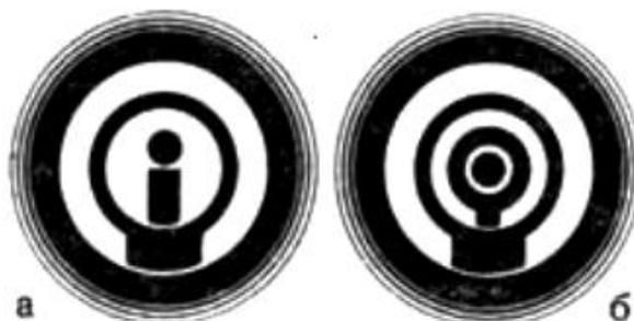
Рис. 3. Прицеливание с диоптрическим прицелом: а) с прямоугольной мушкой, б) с кольцевой мушкой [5]
