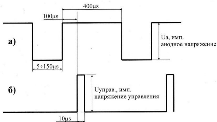
Рис. 4. Временные диаграммы генераторов импульсов.
