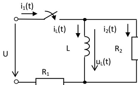
10. Катушка, индуктивность которой равна 0,12 Гн и сопротивление 1 Ом, включается на постоянное напряжение 30 В. Чему равна постоянная времени этой катушки? С какой скоростью нарастает ток в начальный момент? Чему равно установившееся значение тока?
