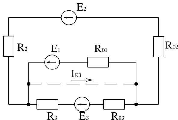
4. Запишите уравнение энергетического баланса для цепи. Определите мощности, отдаваемые источником  $E_3$  и потребляемые приемниками  $E_2$  и  $R_5$ . Дано:  $E_1=100$  В;  $E_2=24$  В;  $E_3=12$  В;  $R_{01}=0,6$  Ом;  $R_{02}=0,2$  Ом;  $R_1=4,4$  Ом;  $R_2=3,8$
