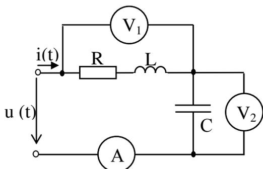
8. Определить показания приборов электромагнитной системы в цепи, схема которой показана на рисунке, записать выражение мгновенного значения тока, если:  $R=50$  Ом,  $\omega L=10$  Ом,  $\frac{1}{\omega C}=90$  Ом.
