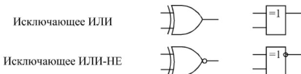
Рис. 1.10. Обозначения элементов «Исключающее «ИЛИ»»: зарубежные (слева) и отечественные (справа)
