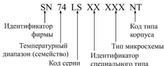
Рис. 1.25. Система обозначений фирмы «Texas Instruments»
