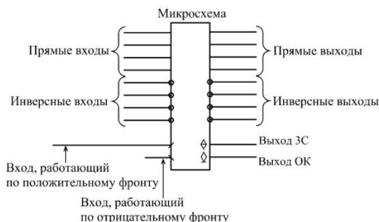
Рис. 1.22. Обозначение входов и выходов
