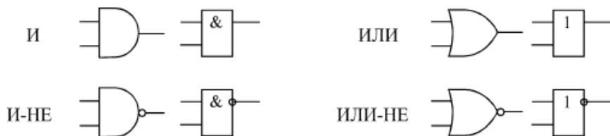
Рис. 1.6. Обозначения элементов «И, И-НЕ, ИЛИ, ИЛИ-НЕ»: зарубежные (слева) и отечественные (справа)
