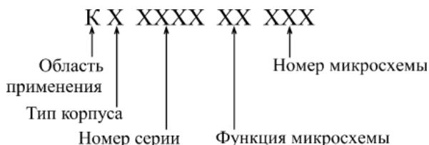
Рис. 1.26. Обозначения отечественных микросхем
