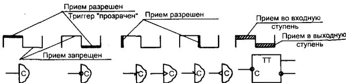
Рис. 2.13. Временные диаграммы, поясняющие работу синхронных триггеров, и условные обозначения тактирующих входов
