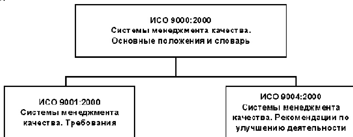
Рис. 1. Структура комплекса стандартов ИСО 9000:2000
