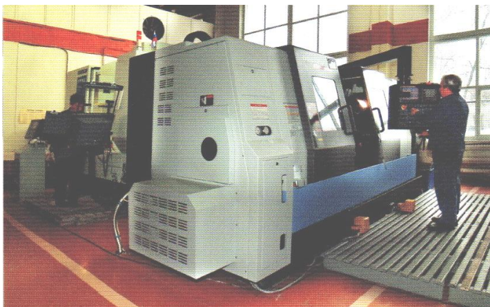
Токарный станок с числовым программным управлением (ЧПУ) для обработки с высокой точностью сложнопрофильных крупногабаритных деталей
