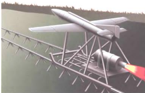
Рис. 1.1. Экспериментальная ракета РНИИ-212 с двигателем ОРМ-65
