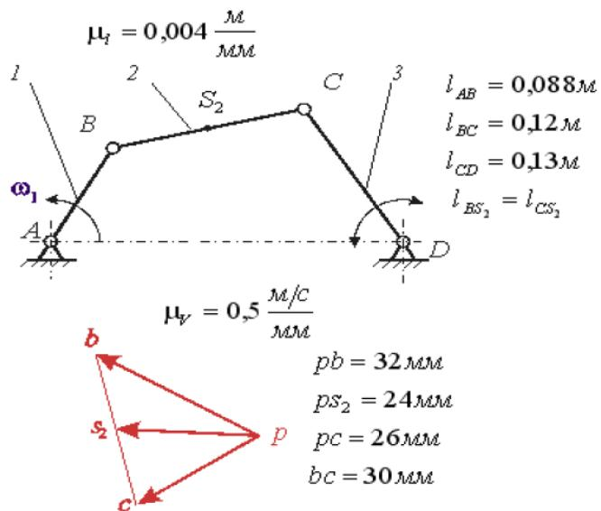
**Вопрос 2.** На рисунке показаны план положений и план скоростей шарнирного четырёхзвенного механизма. Скорость точки S<sub>2</sub> шатуна 2 равна \_\_\_\_\_ м/с (ответ дать с точностью до целых).
