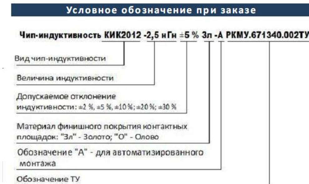
**Рис. 5.4.** Структура ПУО отечественных высокочастотных и сверхвысокочастотных чип-индуктивностей
