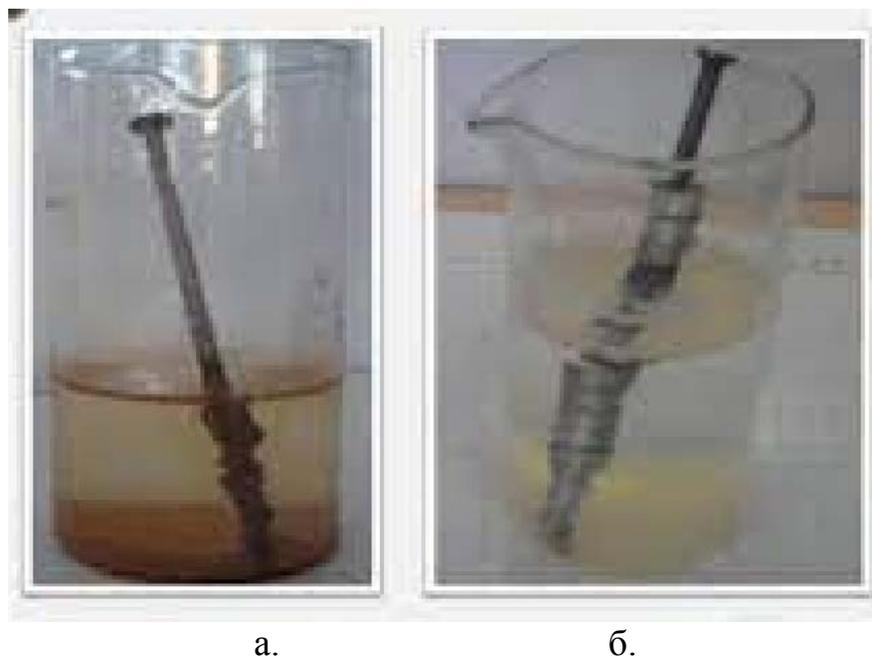
Рис.13 Коррозия при контакте двух металлов – а. железо-медь, б. железо-цинк
