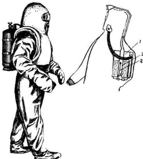
Рис. 8.4. Газотеплозащитный костюм для горноспасателей. Изобретение Г.С.Альтшуллера а.с. № 111 144
