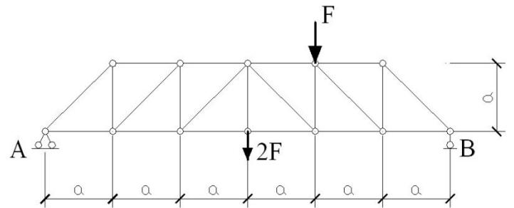
69. Определите реакцию опоры A
