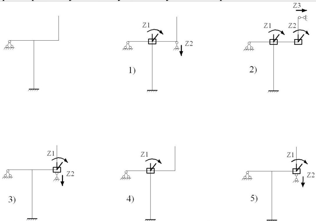
**65.** Определите число избыточных связей стержневой системы
