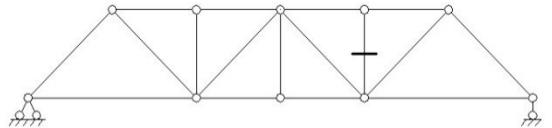
36. Определите усилие в стержне  $V_2$
