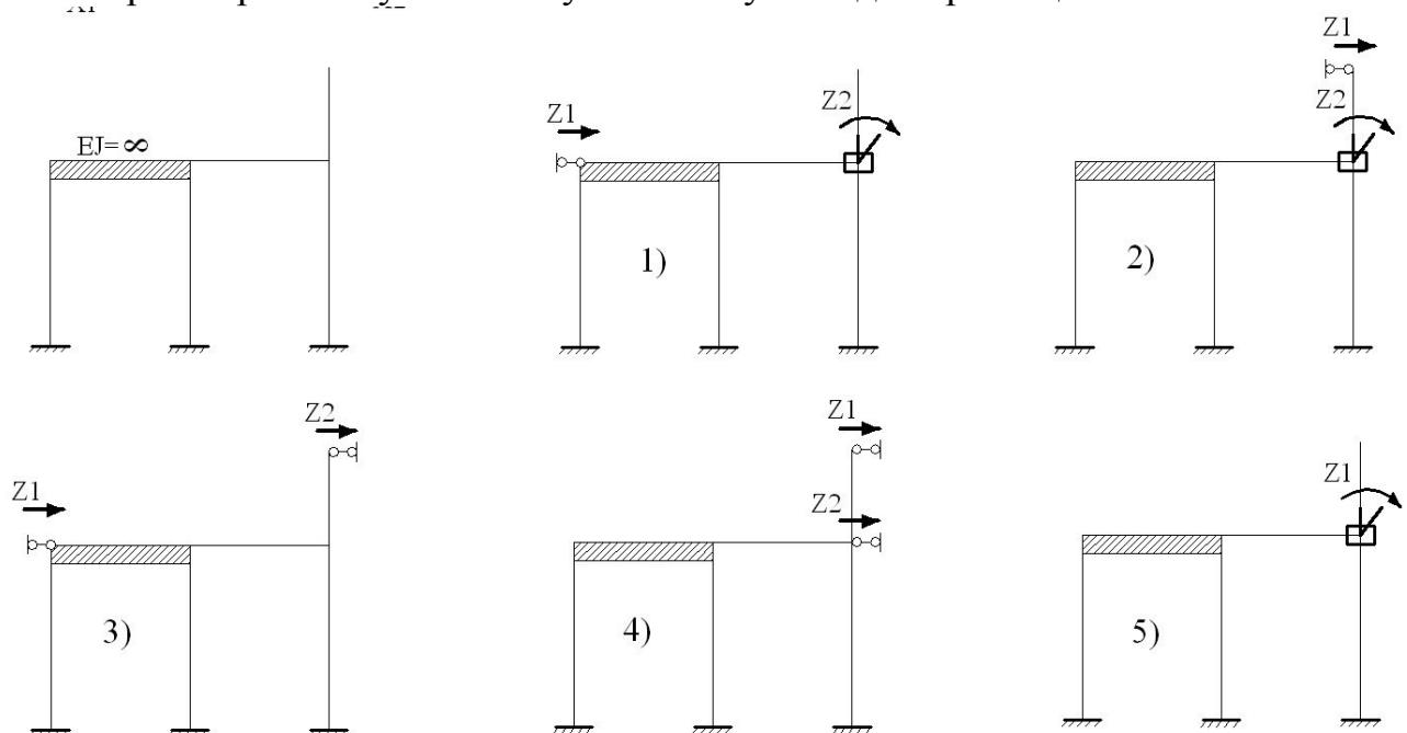
**34.** Определите число избыточных связей стержневой системы
