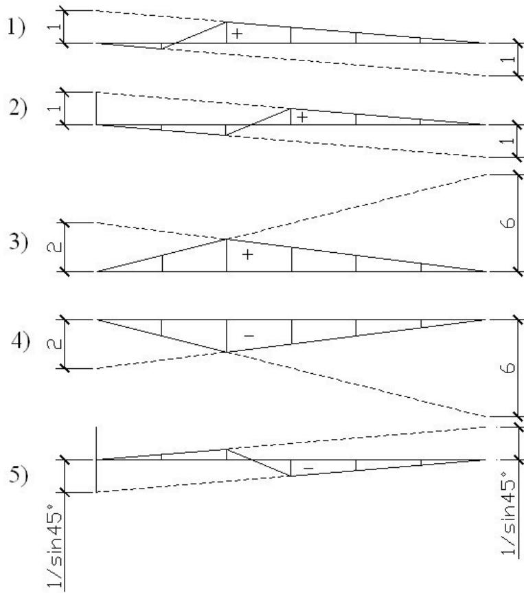
41. Выберите правильное вспомогательное состояние для определения взаимного угла поворота сечений  $A$  и  $B$
