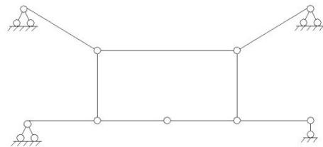
49. Определите число избыточных связей стержневой системы
