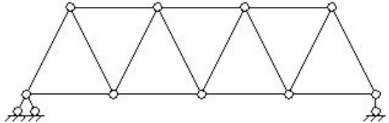
1. Определите число избыточных связей стержневой системы
