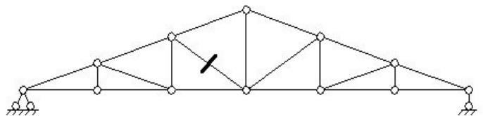
4. Определите усилие в стержне  $O_2$
