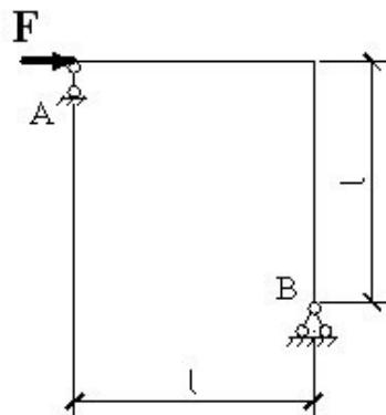
6. Определите поперечную силу в сечении B
