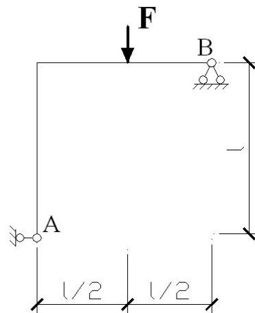
70. Выберите правильное вспомогательное состояние для определения угла поворота сечения A
