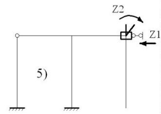
17. Определите число избыточных связей стержневой системы
