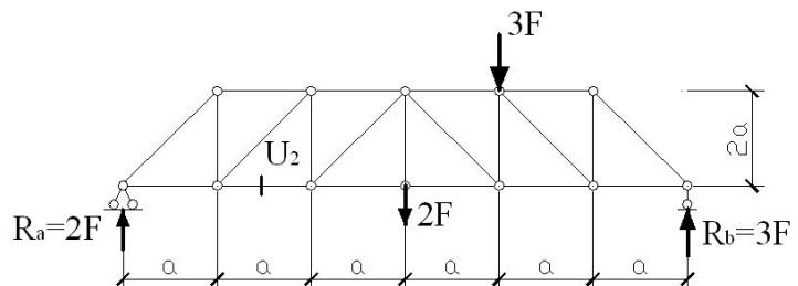
21. Определите вертикальную составляющую опорной реакции в опоре  $B$
