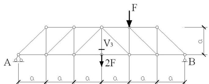
53. Определите вертикальную составляющую опорной реакции в опоре  $B$
