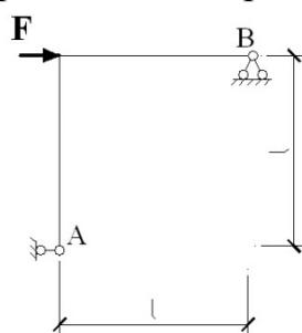
54. Определите продольную силу в сечении  $B$
