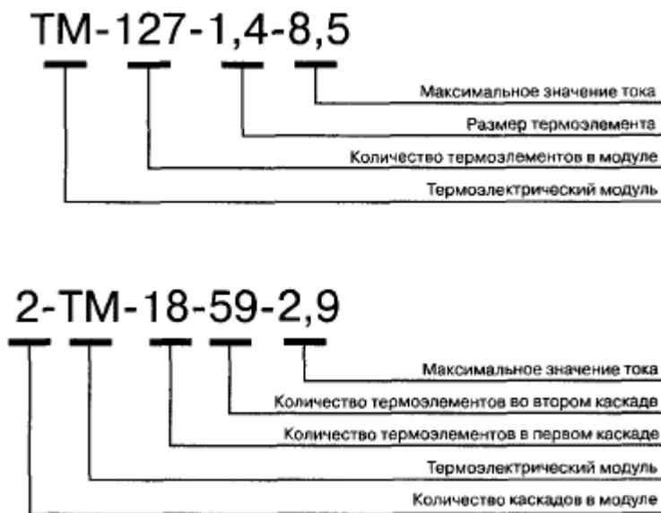
Рис. 3.6 Типы маркировок термоэлектрических модулей типа ТМ
