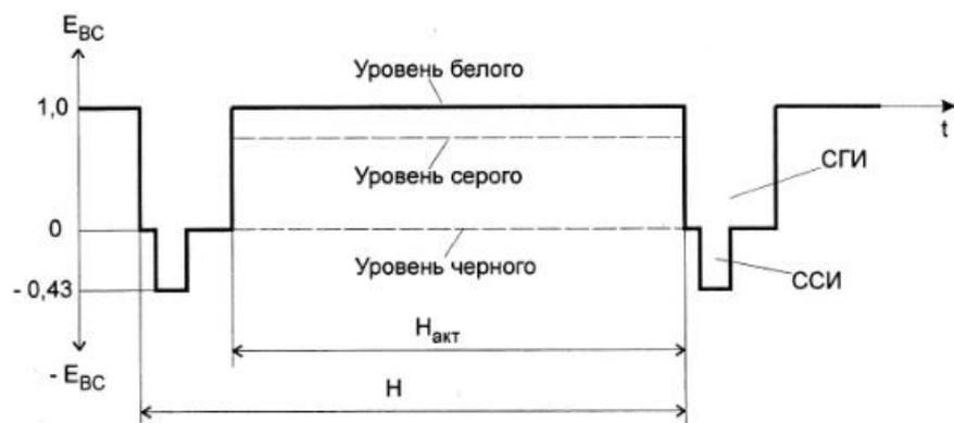
Рис. П2.2. Сигнал белого (серого) поля на интервале строки: СГИ, ССИ – строчные гасящий и синхронизирующий импульсы соответственно
