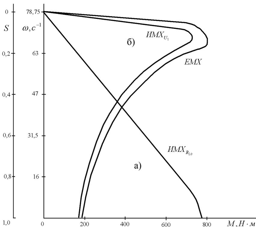
Рис. 4.2. Искусственные механические характеристики асинхронного двигателя с фазным ротором 4MTH200LBV
