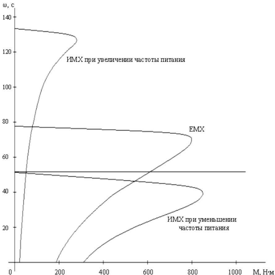
Рис. 4.3. Искусственные механические характеристики двигателя 4МТН200ЛВВ при изменении частоты питания
