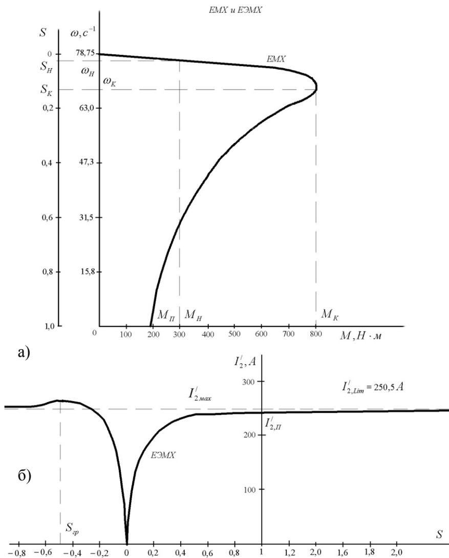
Рис. 4.1. Естественные характеристики асинхронного двигателя с фазным ротором 4МТН200ЛВВ
