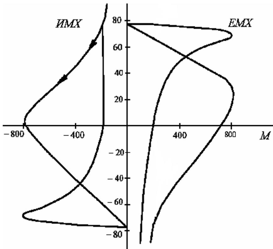
Рис. 4.4. Искусственные механические характеристики асинхронного двигателя с фазным ротором 4MTH200LBV при торможении противовключением
