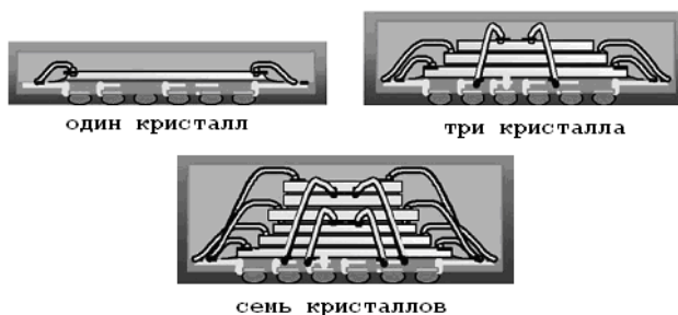
Рис.2.13. Стековые (stacked die) 3D БИС по технологии Non TSV с разваркой выводов и последующей упаковкой в единый BGA-корпус
