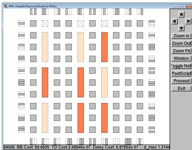
Рис.1.36. Интерфейс инструмента VPR. Гетерогенная архитектура (со встроенными умножителями) ПЛИС с одноуровневой структурой межсоединений (4-х входовая LUT-таблица, размер кластера 10 логических блоков)
