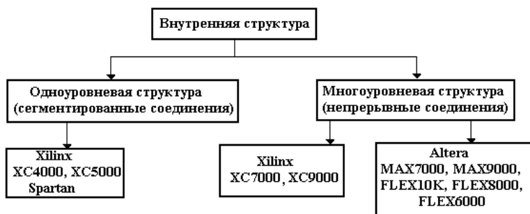
Рис.1.6. Организация внутренней структуры межсоединений в трассировочных ресурсах ПЛИС различных производителей
