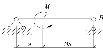
**78.** Определить реакцию в опоре B.
