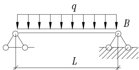
**39.** Определить вертикальную реакцию в опоре В.
