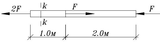
6. Определить напряжения в сечении k-k стержня, если
