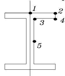
**90.** В балке возникает максимальный момент  $\max M_x = 18 \text{ kH} \cdot \text{m}$ , расчетное сопротивление  $R_u = 150 \text{ MPa}$ . Исходя из условия прочности, определить осевой момент сопротивления  $W_x$ .
