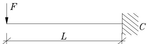
**24. Определить вертикальную реакцию в заделке C.**
