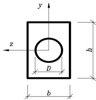
**28.** По какой формуле определяются максимальные нормальные напряжения при поперечном изгибе: 1)  $\sigma = \frac{N}{A}$ ; 2)  $\sigma = \frac{M}{A}$ ; 3)  $\sigma = \frac{Q}{W}$ ; 4)  $\sigma = \frac{M}{I}$ ; 5)  $\sigma = \frac{M}{W}$ ;
