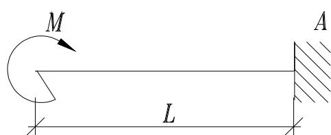
**59.** Определить реакцию в опоре А.
