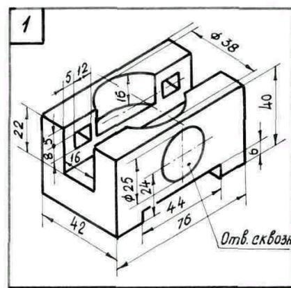
14. Выполнить сложный разрез детали.
