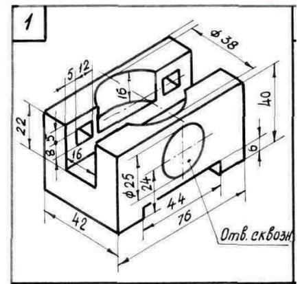
14. Выполнить сложный разрез детали.
