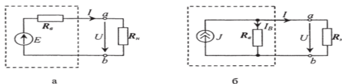
Рис. 18. Схема замещения источников электрической энергии: а - источник ЭДС; б - источник тока (пояснения в тексте)
