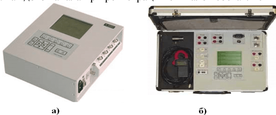
Рис. 24. Приборы контроля: а - синхронный регистратор-анализатор частичных разрядов R2000/N; б - прибор Ганимед
