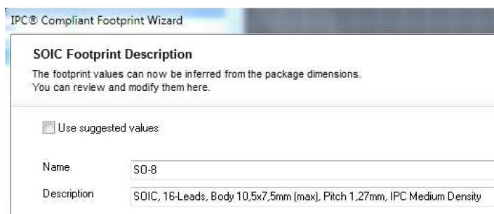
Рис. 17. Описание посадочного места под корпус SO-8
