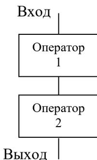
Рис. 2.1. Линейная структура (общий вид)
